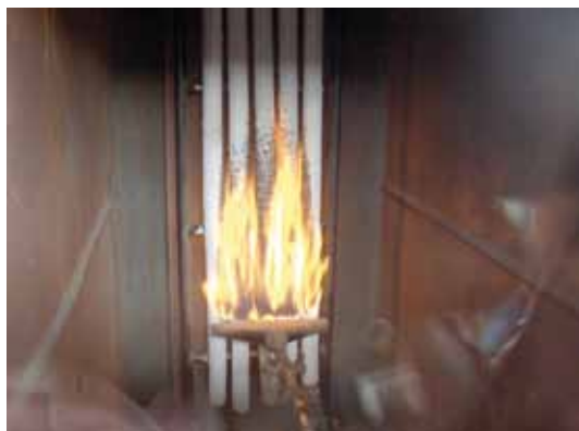
Zkouška nátěru PROMASTOP ® , typ K
