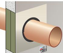
Chceme vás informovat o úspěšně klasifikaci těsnění plastového potrubí s hořlavou izolací třídy reakce na oheň E ve stropní konstrukci. Na základě provedené zkoušky požární odolnosti nebyly překročeny mezní hodnoty parametrů celistvosti (E) a izolace (I) po dobu 125 minut. Více informací vám sdělí naše technické oddělení.
